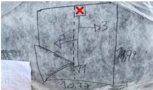
Skizze mit Startpunkt und der geplanten Reihenfolge für das Abrollen und Entfalten der Plane
